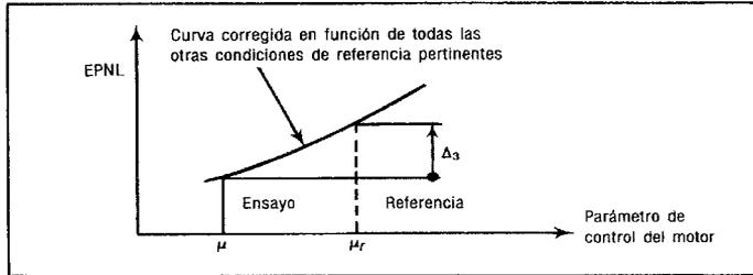
Figura 2-12. Corrección del ruido en función del empuje
