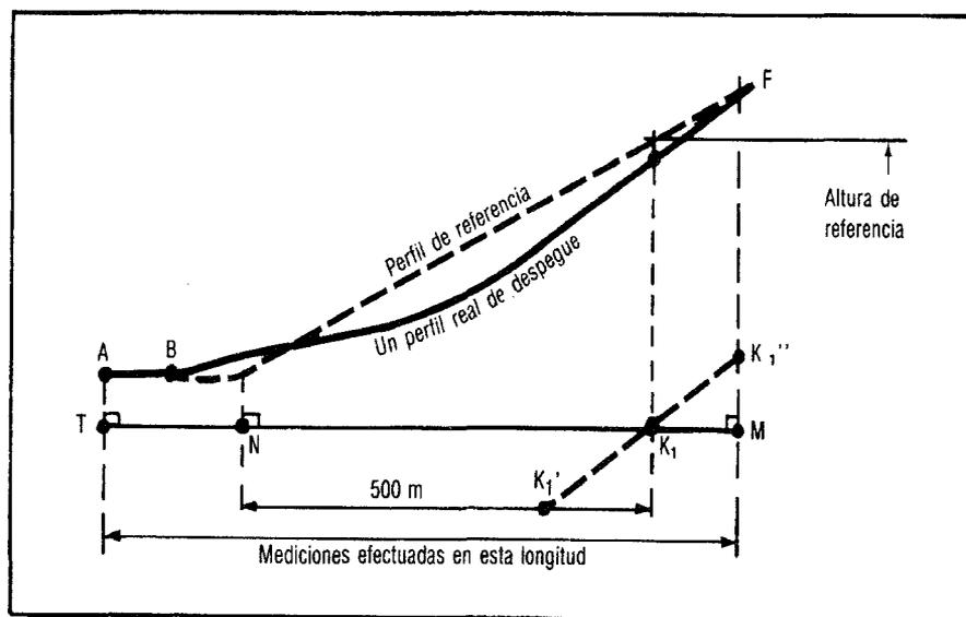
**Figura 2-4. Perfiles típicos de ensayo y de referencia**
